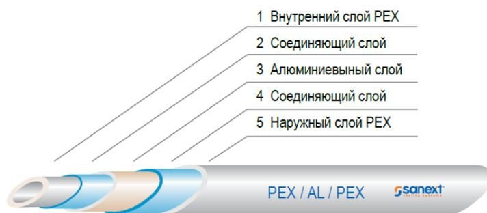
Трубы SANEXT «Стабил» состоят из основного слоя сшитого полиэтилена PEX-с натурального цвета (прозрачный) и антидиффузионного слоя алюминия и наружного слоя сшитого полиэтилена PEX-с белого цвета. Между слоев располагается соединяющий полимерный слой.
