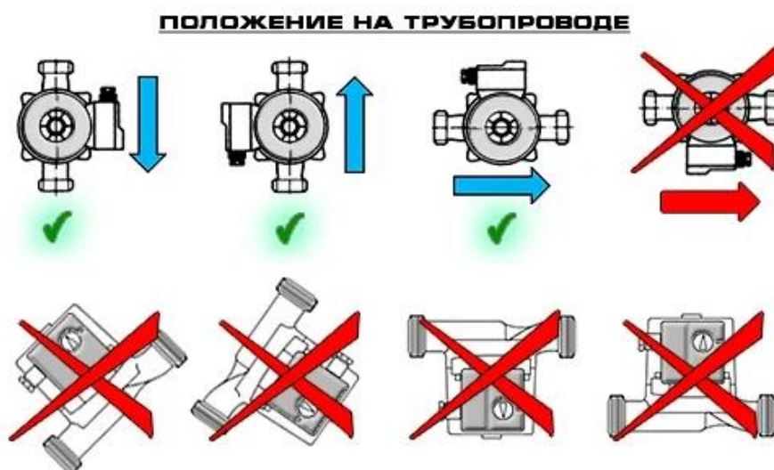
Рисунок 2 – Допустимые положения насоса
