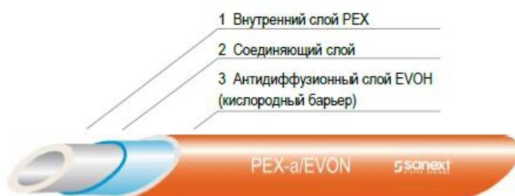
Трубы SANEXT «Тёплый пол» состоят из несущего слоя сшитого полиэтилена PEX-а натурального цвета (прозрачный) и антидиффузионного слоя EVON серого цвета. Слои соединены между собой с помощью эластичного клея.
