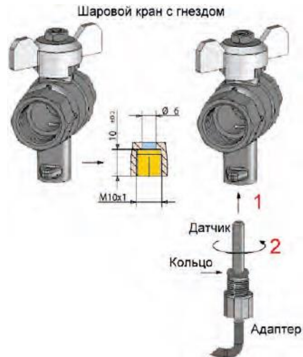
Рис. 1.5. Монтаж термодатчика в гнездо шарового крана
