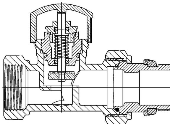
1. Корпус клапана, латунь
