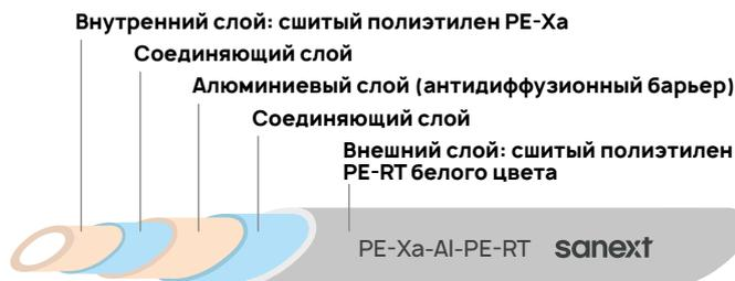
Трубы SANEXT «Стабил» состоят из основного внутреннего слоя сшитого полиэтилена натурального цвета (прозрачный), слоя алюминия, и наружного слоя сшитого полиэтилена белого цвета. Между слоев располагается соединяющий полимерный слой.
