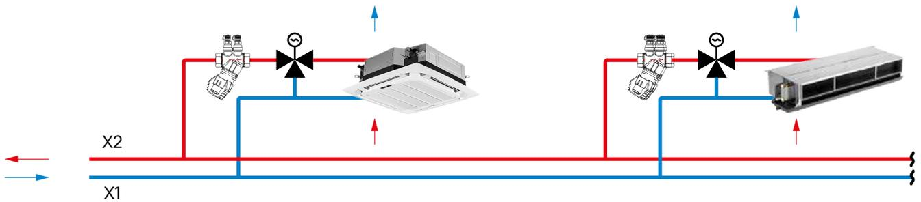
Пример применения SANEXT FLV в обвязках фанкойлов, панелей лучистого обогрева или охлаждения и других вентиляционных установок в качестве автоматического балансировочного клапана – стабилизатора расхода.
