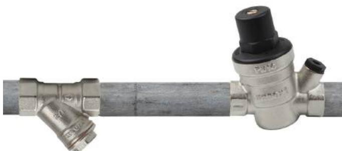
Клапан редукционный может устанавливаться в любом положении. Перед установкой необходимо удостовериться, что направление потока, указанное стрелкой на корпусе редуктора, совпадает с направлением потока рабочей среды в системе, а также убедиться, что во время транспортировки и монтажа, в изделие не произошло попадание инородных частиц, при необходимости очистить и промыть.
