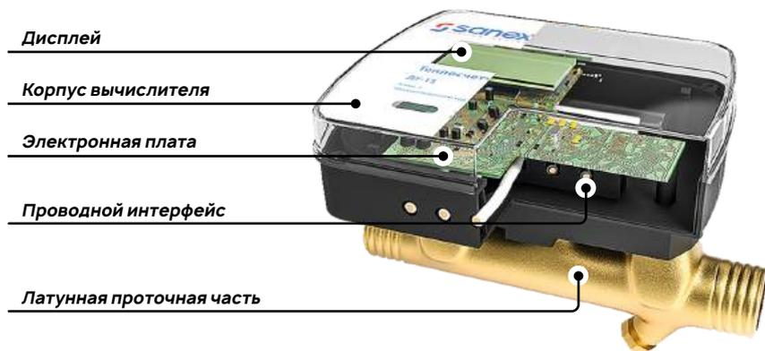
Вычислитель оформлен в виде модуля, содержащего микропроцессор, жидкокристаллический индикатор, клавишу управления, оптический порт передачи данных и автономный источник питания – литиевую батарею. Корпус вычислителя поворачивается в плоскости расходомера на 360° с шагом 90°. Кроме того, вычислитель выносного типа и может устанавливаться отдельно от проточной части на расстоянии до 50 см.
