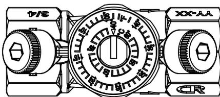
Чтобы установить желаемую температуру циркуляции, поворачивайте механизм регулировки до тех пор, пока желаемая температура системы не совпадет с отметкой селектора.
