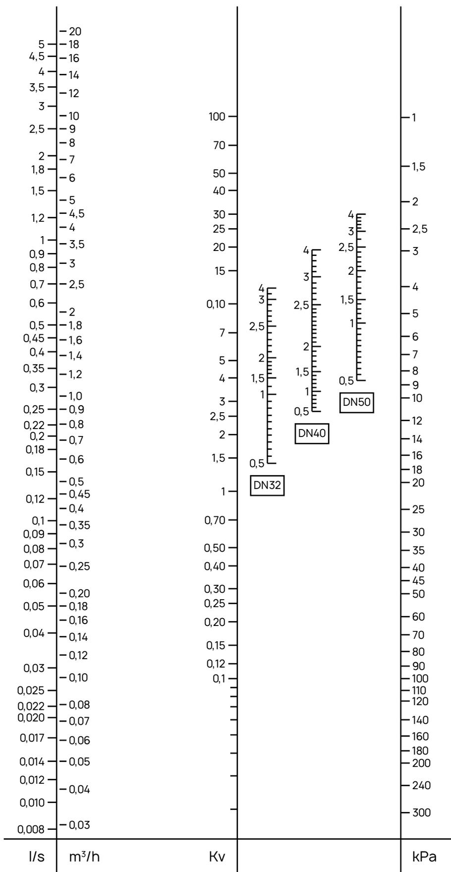
Графики пропускной способности ручных балансировочных клапанов SANEXT STP с резьбовым соединением
