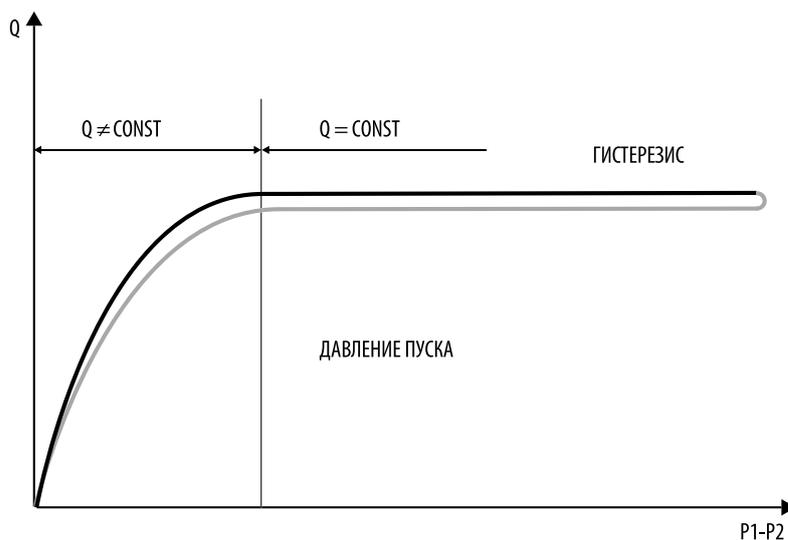
Постоянный расход через клапан обеспечивается только в рабочем диапазоне давлений. Клапан находится в рабочем диапазоне, если измеренный перепад давления в точках P1-P2 выше пускового значения.
