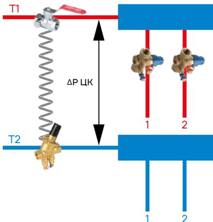
**Необходимо:** подобрать автоматический балансировочный клапан для установки перед этажным коллектором системы отопления, указать настроечные значения.
