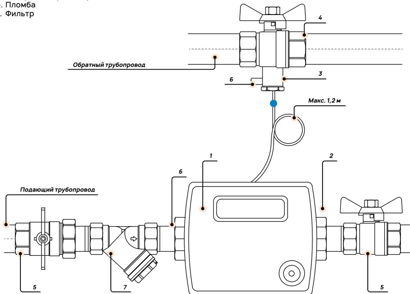
**Принципиальная схема общая обратный трубопровод**
