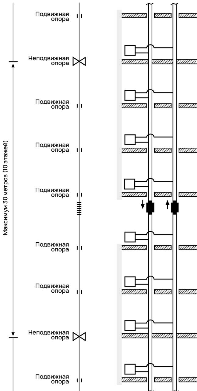
1. Компенсатор устанавливается на прямом участке трубопровода, между неподвижными опорами. Изгибы трубопровода на данном участке не допускаются. Линейное удлинение трубопровода не должно превышать компенсирующую способность компенсатора.
