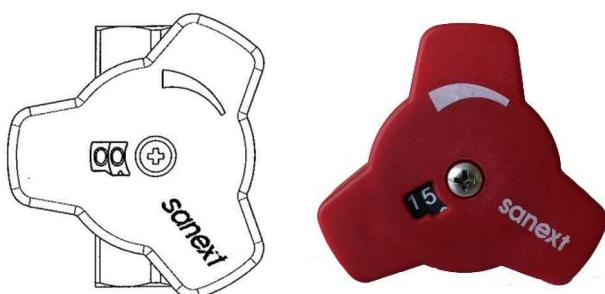
Для установки гидравлической настройки клапана STP-H поворачивать рукоятку клапана до появления в индикационном окне необходимого значения. При использовании клапана в качестве запорного необходимо повторно установить значение преднастройки.
