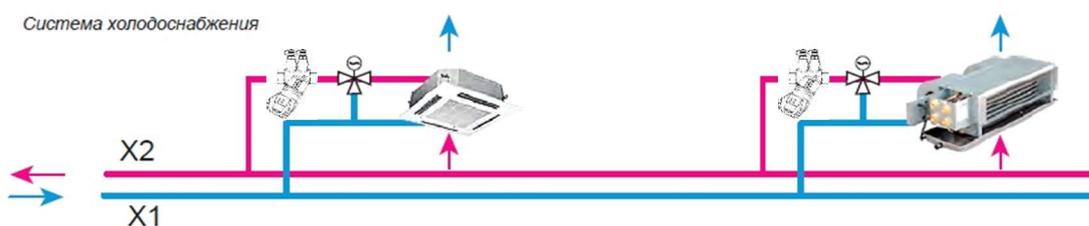
Пример применения SANEXT FLV в обвязках фанкойлов, панелей лучистого обогрева или охлаждения и других вентиляционных установок в качестве автоматического балансирующего клапана – стабилизатора расхода.
