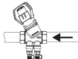
При установке клапана необходимо оставить достаточное пространство вокруг контрольных точек для обеспечения места подключения измерительного прибора.
