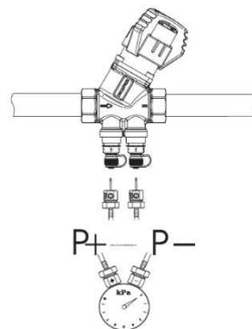
Измерить параметры рабочей среды можно с помощью Измерительного прибора SANEXT. Прибор подключается к клапану через измерительные ниппели (входят в стандартный комплект поставки).
