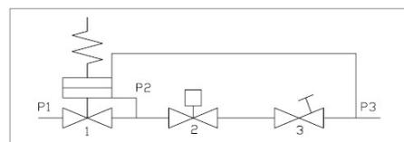
Действие диафрагмы направлено в противоположную сторону от направления движения пружины, с целью выровнять перепад давления и предотвратить колебание мембраны.
