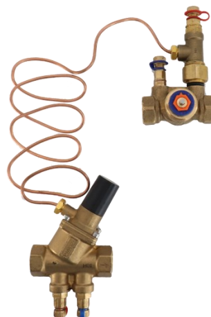
Рисунок 5 – Пример использования ручного балансировочного клапана SANEXT STP в качестве клапана-партнера автоматического балансировочного клапана SANEXT DPV. Клапан SANEXT STP входит в регулируемый участок автоматического балансировочного клапана SANEXT DPV. Возможно подключение измерительного прибора к клапану SANEXT STP.
