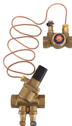
Рисунок 7 – Пример использования ручного балансировочного клапана SANEXT STP в качестве клапана-партнера автоматического балансировочного клапана SANEXT DPV. Клапан SANEXT STP входит в регулируемый участок автоматического балансировочного клапана SANEXT DPV.
