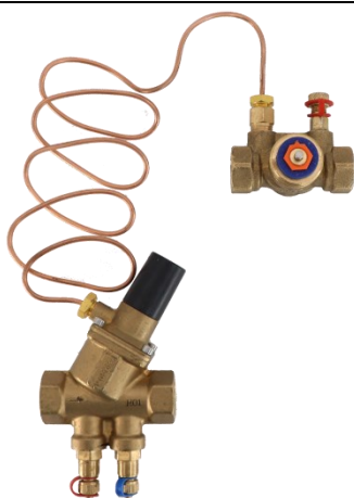
Рисунок 4 – Пример использования ручного балансировочного клапана SANEXT STP в качестве клапана-партнера автоматического балансировочного клапана SANEXT DPV. Клапан SANEXT STP не входит в регулируемый участок автоматического балансировочного клапана SANEXT DPV. Возможно подключение измерительного прибора к клапану SANEXT STP.
