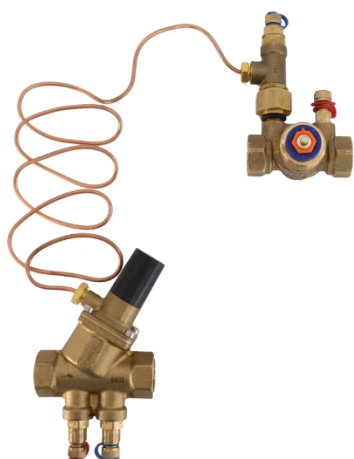
Рисунок 4 – Пример использования ручного балансировочного клапана SANEXT STP в качестве клапана-партнера автоматического балансировочного клапана SANEXT DPV. Клапан SANEXT STP не входит в регулируемый участок автоматического балансировочного клапана SANEXT DPV. Возможно подключение измерительного прибора к клапану SANEXT STP.
