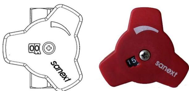
Для установки гидравлической настройки клапана STP-H поворачивать рукоятку клапана до появления в индикационном окне необходимого значения. При использовании клапана в качестве запорного необходимо повторно установить значение преднастройки.
