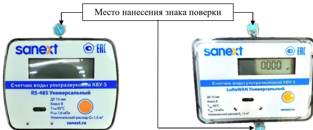
Р и с у н о к 2 – Схема пломбировки от несанкционированного доступа, обозначение места нанесения знака поверки
