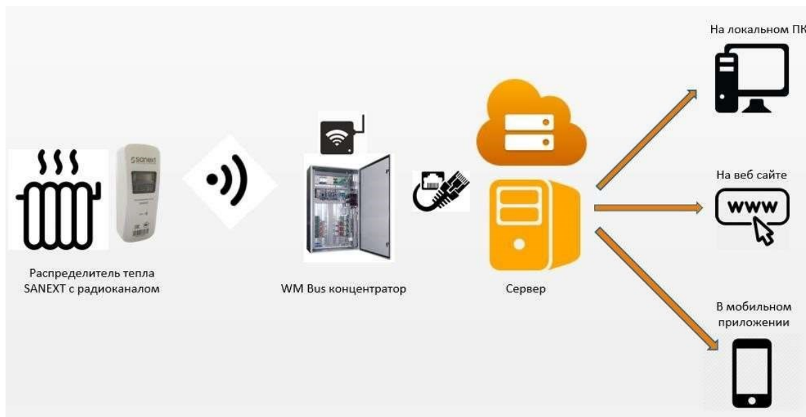
Рисунок 2 – Типовая схема чтения и передачи данных по радиоканалу Wireless Mbus
