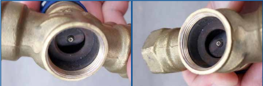
Пример повреждения уплотнения запорного золотника.
