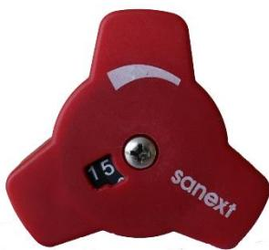
Для установки гидравлической настройки клапана STP-H поворачивать рукоятку клапана до появления в индикационном окне необходимого значения. При использовании клапана в качестве запорного необходимо повторно установить значение преднастройки.
