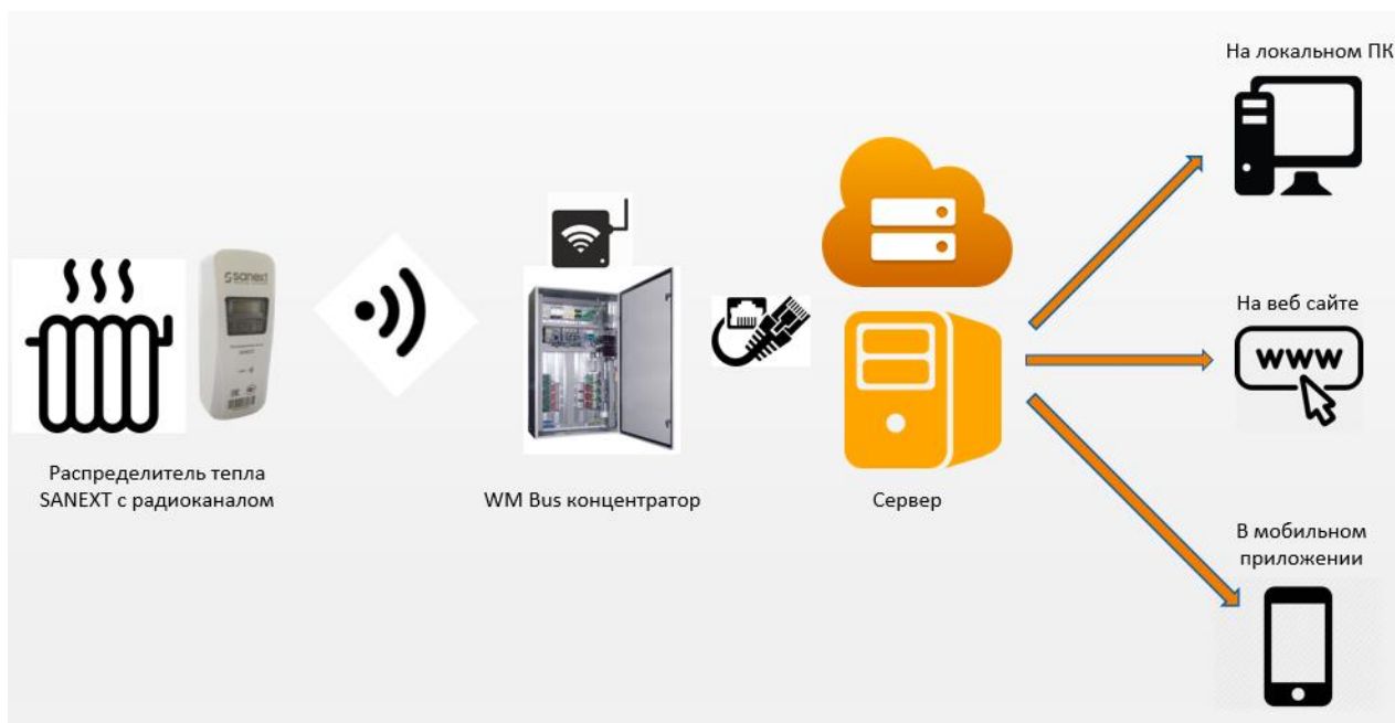
Рис. 2. Типовая схема чтения и передачи данных по радиоканалу Wireless Mbus
